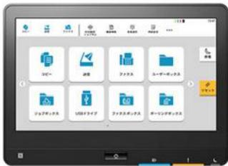
画面をタッチして左右に移動できるスワイプ対応のカラー液晶操作パネルを搭載。プレビュー画面ではピンチアウトで拡大、ピンチインで縮小表示も可能です。
